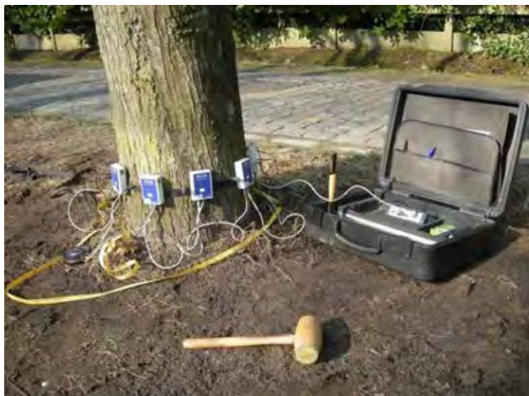
Figuur 1. Opstelling van de tomograaf.
